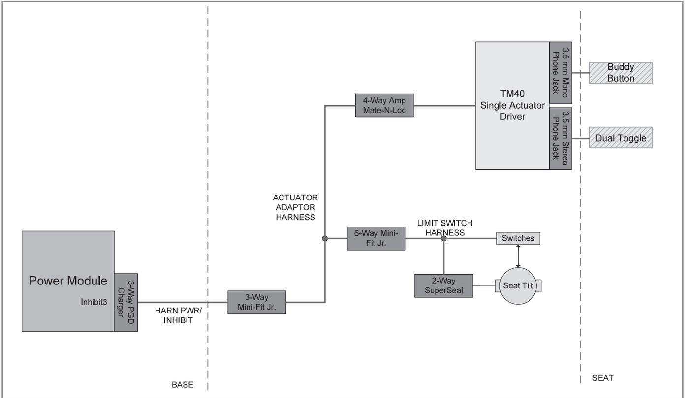
**SWITCH DRIVEN SINGLE ACTUATOR DRIVER CONNECTIONS**
