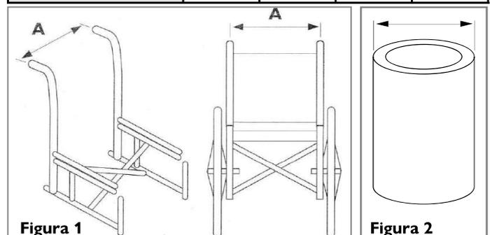
Después, compruebe que los tubos posteriores son de un diámetro compatible. Se pueden utilizar fijaciones de montaje posterior de tipo tirantes en tubos posteriores de 0,62 a 1, 1 pulgadas (16 mm a 28 mm) de diámetro. (Fig. 2)
