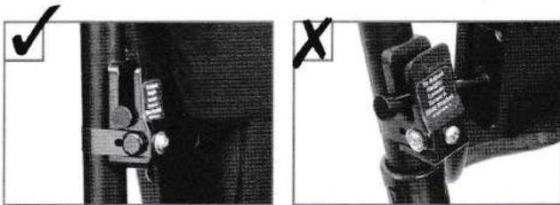
Asegúrese de que el dispositivo de sujeción de un cuarto de vuelta que está en el tubo del respaldo de la silla de ruedas esté girado hacia abajo en su posición bloqueada.
