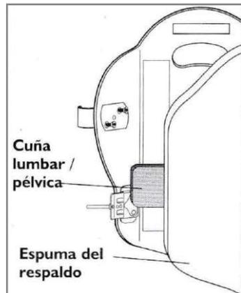
**INSTALACIÓN DEL DISPOSITIVO DE SOPORTE DE LIBERACIÓN RÁPIDA MEDIANTE UN CUARTO DE VUELTA**
