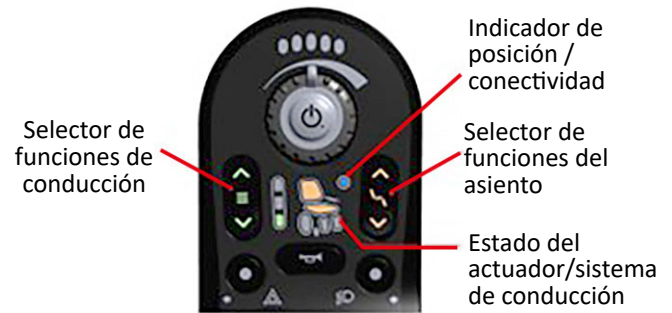
Figura 19: Selección y funcionamiento de una posición de memoria (REM2xx)
