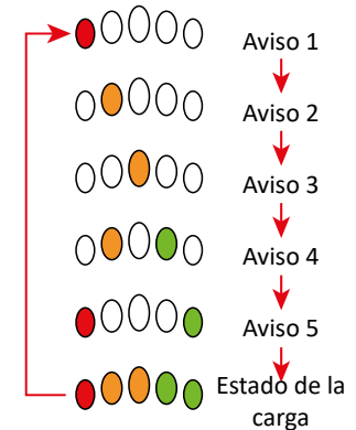
Figura 66: Secuencia de aviso durante la recarga de la batería
