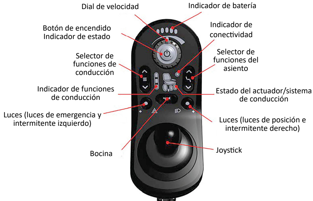
Figura 3: Interfaz de usuario del REM215 y REM216
