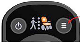
Figura 44: Cambio de la función de conducción mediante el botón de modo
