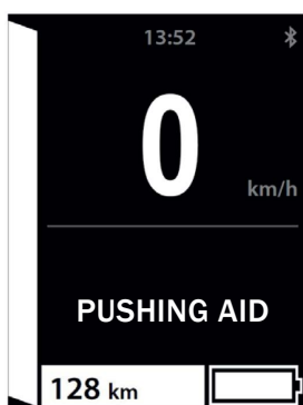
Figura 10: Activación de la ayuda para empujar
