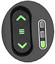
Figure 16 : Bouton de sélection et affichage de la fonction de conduite
