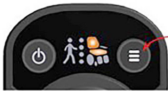
Figure 44 : Changement de la fonction de conduite via le bouton Mode
