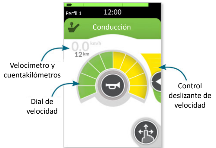
Fig. 7.1: Pantalla de conducción con indicador de velocidad/cuentakilómetros, dial de velocidad y control deslizante de velocidad
